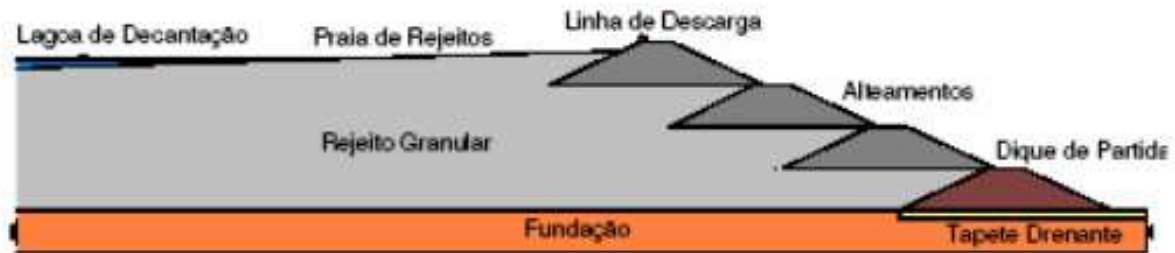
Alteamento a montante
