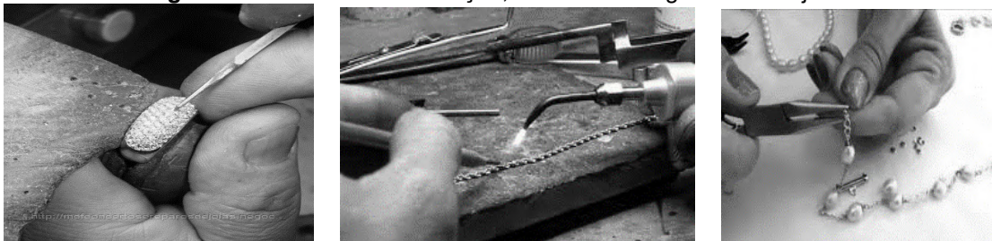
Figura 2 - Processo de Cravação, solda e montagem de semijoias
