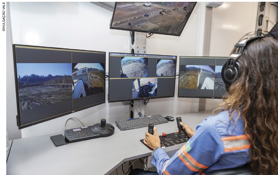
Operadores ficam a um quilômetro de distância manejando equipamentos remotamente
