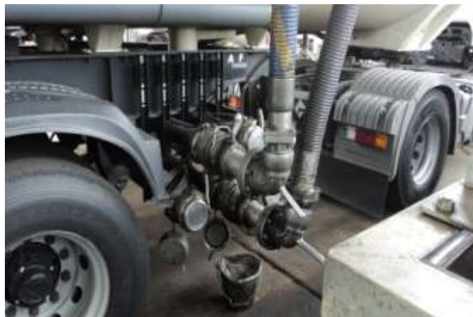
Vista de recipiente metálico para coleta de resíduos líquidos de derivados de petróleo, ainda utilizado no carregamento boton loading , uma das possíveis fontes secundárias de vaporização da fração volátil dos compostos.
