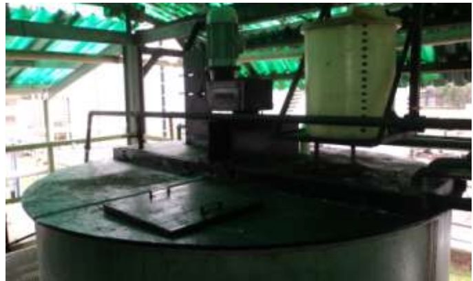
Idem à anterior. Observe-se que há um fechamento parcial da área, mas nenhum sistema de ventilação local exaustora para os eventuais contaminantes voláteis formados.
