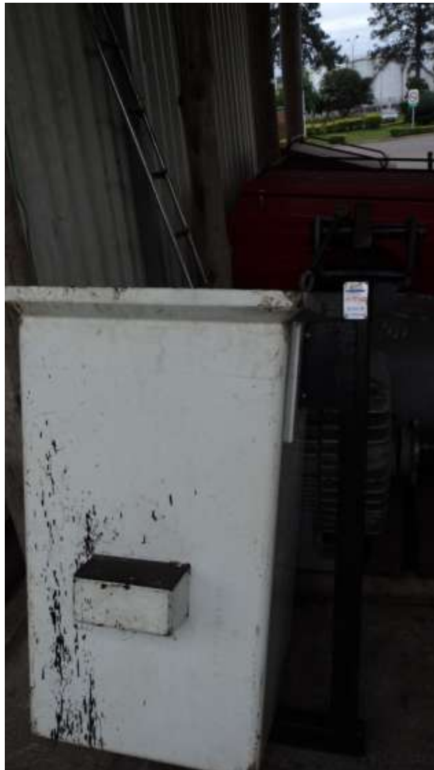
Cesto de fibra que é acoplado ao guindauto. Inobservância dos requisitos técnicos e legais para o transporte vertical de pessoas.
